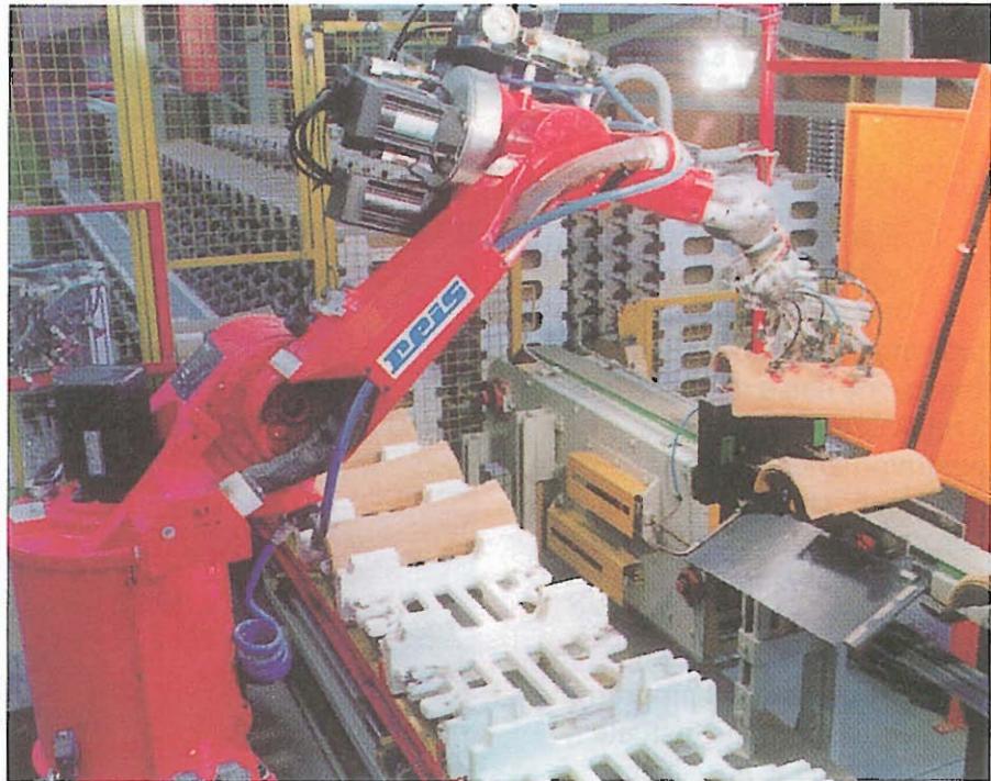
Manipolazione di tegole in un sistema robotizzato di Reis, aiutato da un dispositivo di elaborazione di immagini.
