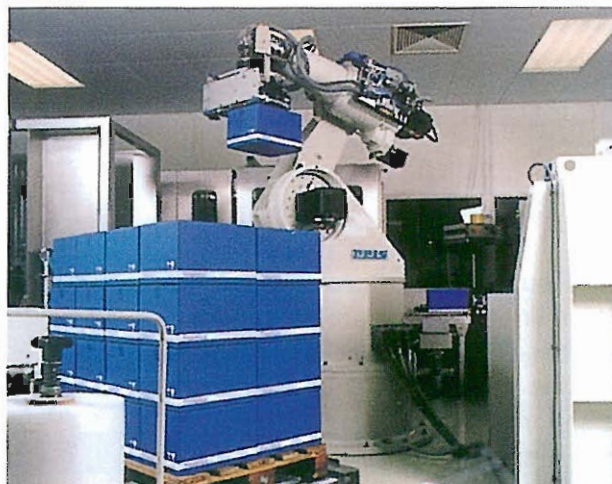
Sistema robotizzato REIS di pallettizzazione di contenitori.
