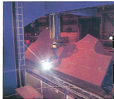
Nell'industria metallurgica i robot Motoman sono dedicati al processo di saldatura di grandi pezzi, date le loro straordinarie capacità di carico e la loro elevata velocità.
