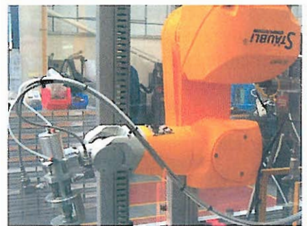
In ogni isola di montaggio degli aspirapolvere si trova un robot montato a soffitto.
