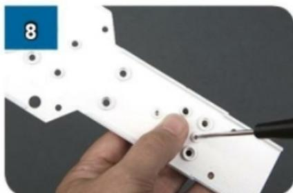
Capovolgila e usa altre due viti da 2x6 mm per fissare il cilindro alla placca.
