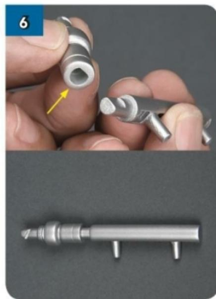
Prendi il pistone del braccio idraulico (LPR-05) e individua la fessura a forma di "D" indicata in foto. Metti una goccia di supercolla (a base di cianoacrilato) al suo interno e poi inserisci dentro l'estremità del cilindro del braccio idraulico (LPR-06) che presenta la stessa
