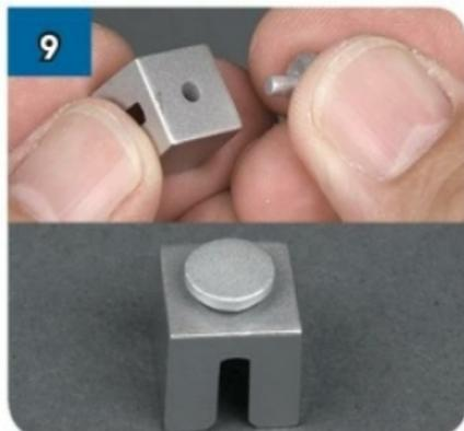
Per inserire il tappo otturatore (LPR-04) sull'accoppiatore del braccio idraulico (LPR-03), metti una goccia di supercolla sul perno del tappo e poi inseriscilo completamente nel foro dell'accoppiatore.
