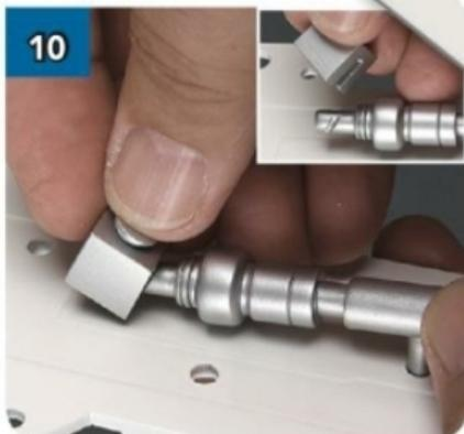
Allinea la fessura sul lato di LPR-03 con la guida all'estremità di LPR-05 (vedi sopra). Metti una goccia di supercolla nella fessura e fai scorrere LPR-03 su LPR-05. Tieni premuto finché la colla non si sarà asciugata.
