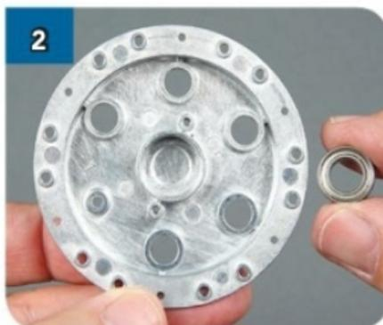
2 Come si è visto nel punto 1, sul fronte di DF-01 c'è un profilo in rilievo a forma di buco della serratura. Sul retro della piastra invece c'è un incavo circolare.
