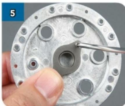
5 Posiziona DF-10 sopra al cuscinetto e usa una delle viti argentate da 2x4 mm per fissare una delle estremità.
