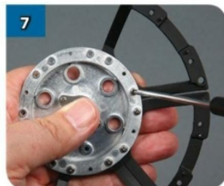
Inizia a fissare il supporto alla piastra metallica del telaio con una vite e un dado come fatto prima, nei passaggi 2-4.
