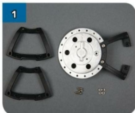
Recupera le parti del telaio assemblate nella Fase 5, i due nuovi supporti (DF-04), e ancora quattro viti argentate da 2,3x6 mm e quattro dadi M2 (dello stesso tipo di quelli usati nella Fase 5).
