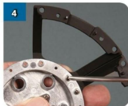
Mantenendo il dado in posizione con la punta del dito indice, capovolgi il telaio e avvita una vite da 2,3x6 mm nel foro della piastra DF-01 in corrispondenza del dado.
