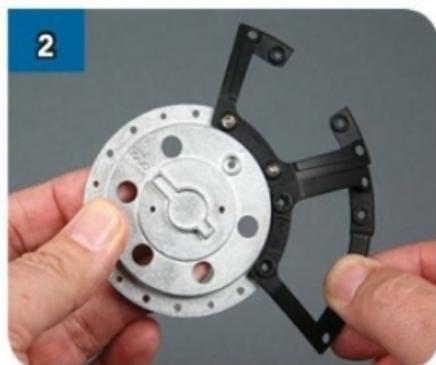
Posiziona uno dei supporti del telaio (DF-04) come mostrato, allineando i fori per le viti a quelli della piastra (DF-01). Infilare il perno che si trova sotto DF-04 nel relativo foro di DF-01.
