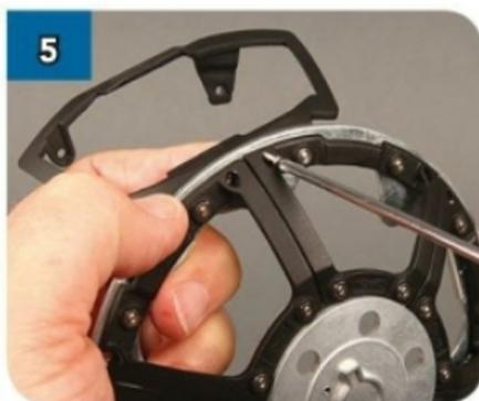
Mantieni il dado in posizione con un dito, capovolgi la parte assemblata e inserisci dall'alto una vite da 2x6mm. Avvitala.
