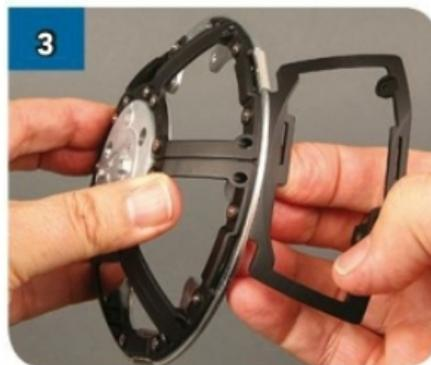
Unisci i pezzi in modo che i due perni presenti a lato dei due fori di DF-11 si infilino nei corrispondenti fori dell'anello metallico del telaio superiore.
