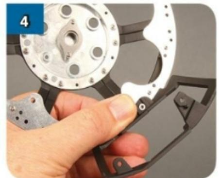
Tieni il DF-11 in posizione e inserisci un dado M2 nella cavità esagonale che trovi sul lato inferiore di DF-11.
