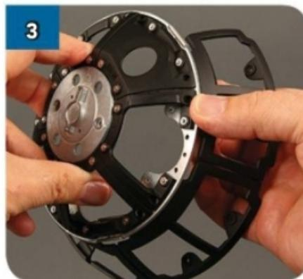
Unisci i pezzi in modo che i due perni presenti a lato dei due fori di DF-12 si infilino nei corrispondenti fori dell'anello metallico del telaio superiore.
