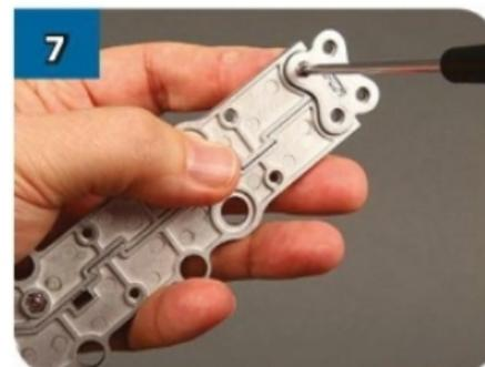
Capovolgili i pezzi, tieni il dado in sede e inserisci una vite 2,5x6 mm. Ripeti i punti 6 e 7 e fissa la piastra con l'altra vite e relativo dado.
