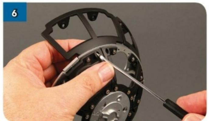
Ripeti i passaggi 4 e 5 per fissare DF-12 al telaio con un'altra vite e un altro dado.
