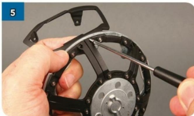
Mantieni il dado in posizione con un dito, capovolgila la parte assemblata e inserisci dall'alto una vite da 2x6 mm. Avvitala.
