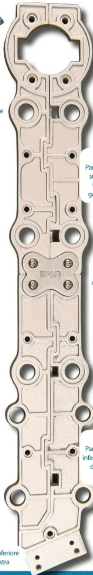
**LFR-14** Parte posteriore superiore del telaio della gamba destra
