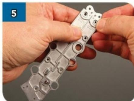
Posiziona la piastra di collegamento LFR-17 all'estremità superiore della parte assemblata, incastra i suoi due perni in LFR-15 e LFR-16.
