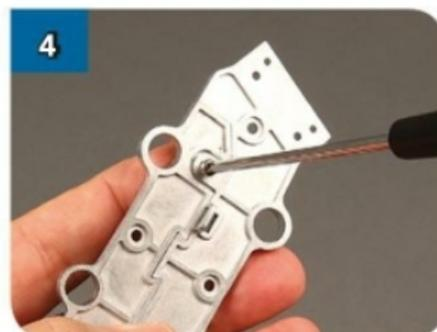
Tenendo il dado in posizione, capovolgili i pezzi, inserisci una vite nel foro dell'aletta di LFR-15 e avvitala in modo che faccia presa con il dado posizionato nel passaggio 3.
