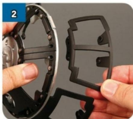
Posiziona DF-13 come mostrato, allineando i suoi due fori in alto con i fori corrispondenti sui supporti del telaio superiore. Nota bene come è orientato il telaio superiore.
