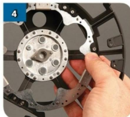
Capovolgili i pezzi tenendo DF-13 in posizione e inserisci un dado M2 nella cavità esagonale che trovi sul lato inferiore di DF-13.
