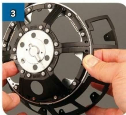
Unisci i pezzi in modo che i due perni presenti a lato dei due fori di DF-13 si infilino nei corrispondenti fori dell'anello metallico del telaio superiore.
