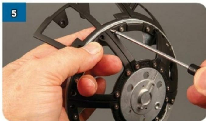
Mantenendo il dado in posizione con la punta del dito indice e avvita una vite in corrispondenza del dado.
