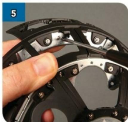
Mantieni il dado in posizione con un dito, capovolgì la parte assemblata e inserisci dall'alto una vite da 2x6 mm. Avvitala.
