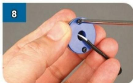
Fissa insieme tutti i pezzi che hai montato avvitando le due viti nere autofilettanti da 2,3x4 mm.
