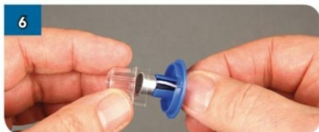
Inserisci la lente trasparente sopra il microfono e spingila fino alla base del supporto.
