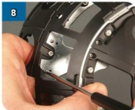
8 Capovolgli il telaio e avvita una vite nel foro corrispondente dell'anello. Ripeti l'operazione per fissare DF-23 con l'ultima vite e il dado.
