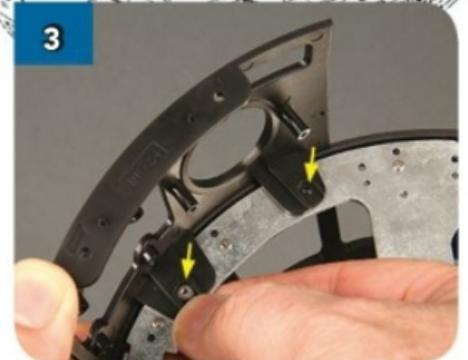
3 Capovolgli i pezzi e tenendo DF-24 in posizione inserisci un dado M2 in una delle due sedi esagonali indicata dalla freccia gialla.
