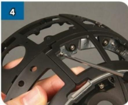
4 Tieni il dado in posizione, capovolgli ancora il telaio e avvita una vite da 2x6 mm nel foro dell'anello in corrispondenza del dado.
