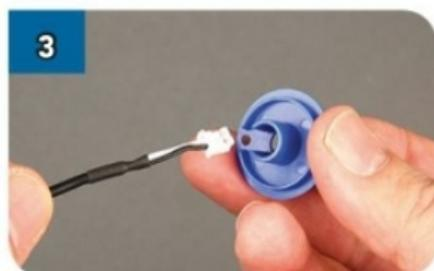
Inserisci il connettore del cavo all'interno del supporto come mostrato in foto.
