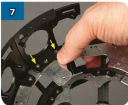
7 Tenendo DF-23 in posizione capovolgli il telaio e inserisci il primo dado in una delle due sedi esagonali del supporto.
