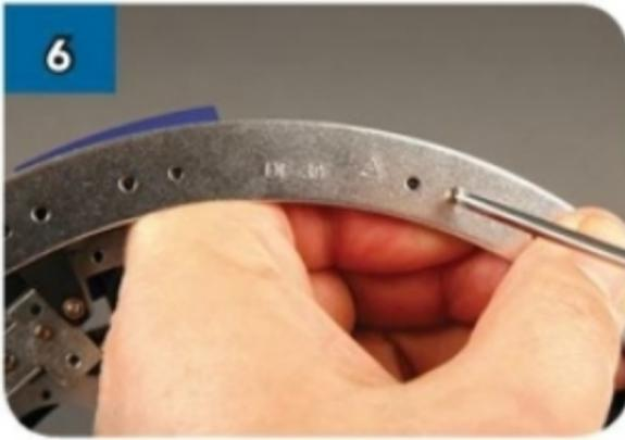
Mantenendo il dado in posizione con le dita, infila una vite nel foro sul lato sottostante dell'arco metallico e avvitala.
