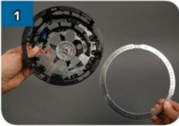
Prendi l'anello appena montato e avvicinalo alla base del telaio della cupola come mostrato sopra e nel disegno a destra. Poi sovrapponili.
