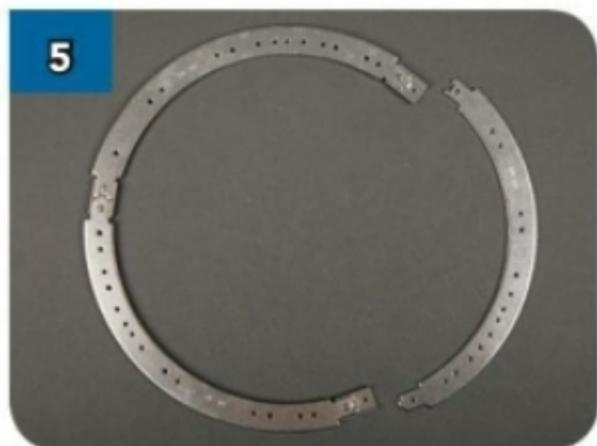
Avvita le altre due piastre di raccordo DF-08 alle altre estremità di DF-38 e DF-39. Utilizzando sempre viti da 2x4 mm.
