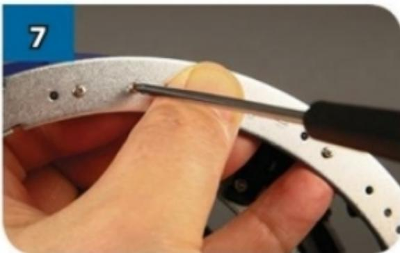
Inserisci i dadi e avvita le viti nei restanti 14 fori per fissare bene l'anello al telaio. Osserva bene il disegno in alto a destra per individuare dove inserire i dadi e le viti.
