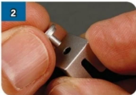
Applica una goccia di supercolla sul perno di LPR-04 prima di inserirlo nel foro apposito di LPR-03.
