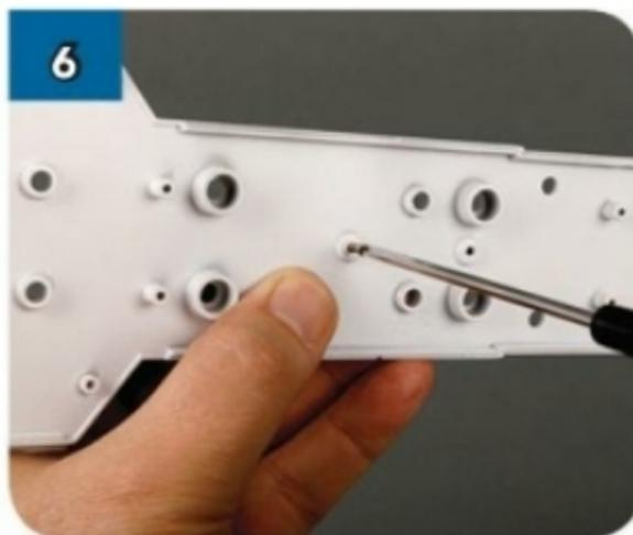
Capovolgi la parte appena montata e fissa il primo perno con una vite da 2x6 mm.
