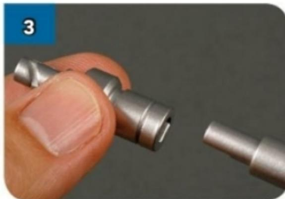
Metti una goccia di supercolla all'interno della fessura a "D" del pistone LPR-05. Poi inserisci l'estremità del cilindro LPR-06 sagomato apposta per entrare nel pistone.
