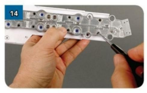
Osserva bene il disegno a destra e poi fissa il telaio metallico alla placca della gamba con otto viti autofilettanti da 2,3x6 mm.
