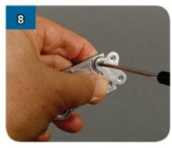
Mantenendo il dado in posizione, avvita una vite da 2,5x6 mm nel dado.
