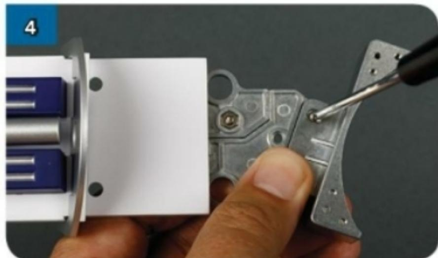
Tieni fermo LFL-05 sul telaio e fissalo, usando le due viti argentate da 2,5x5 mm.
