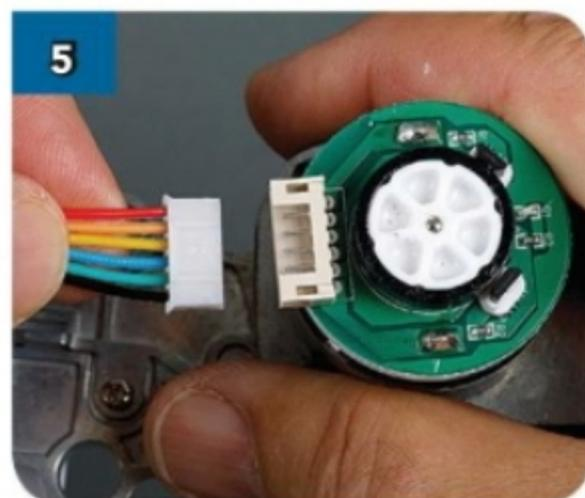
5 Recupera il cavo piatto a sei fili colorati fornito nell'uscita 46 e inserisci il connettore più grande nel connettore del motore.
