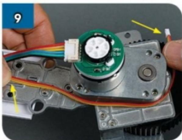
9 Assicurati che la parte libera inferiore del cavo del sensore sia di 135 mm: misura la parte del cavo compresa tra le due frecce in foto.
