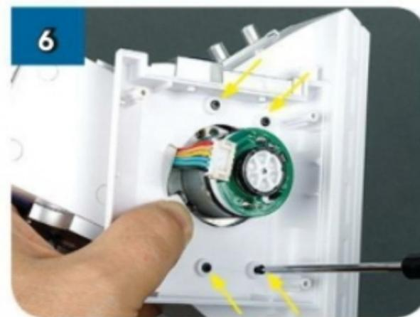
Allinea i quattro fori indicati e avvita la copertura interna al piede con quattro viti nere autofilettanti da 2,3x6 mm.
