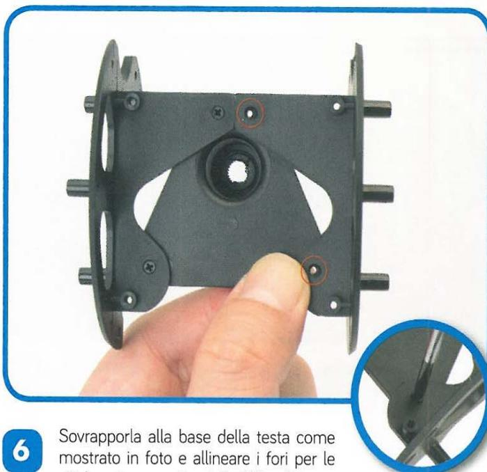
**6** Sovrapporla alla base della testa come mostrato in foto e allineare i fori per le viti. Inserire una vite piatta M2 x 4,5 mm (7) in entrambi i fori e unire la tempia alla base serrando le viti.
