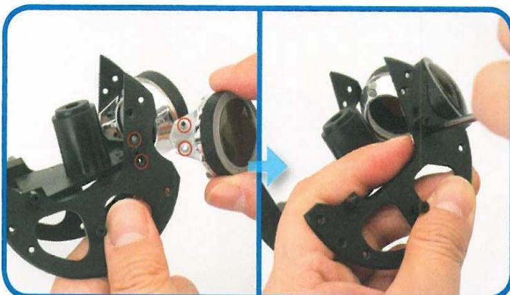
**18** Preparare l'altro occhio per inserirlo nella parte sinistra della testa. Rovesciando la struttura della testa l'operazione risulta più facile. Come si vede in foto: allineare i fori dell'occhio con il terzo e quarto foro dall'alto (se si è rovesciata la testa). Inserire l'occhio e fissare con due viti piatte **(7)** la cornice alla tempia come fatto per l'occhio destro.
