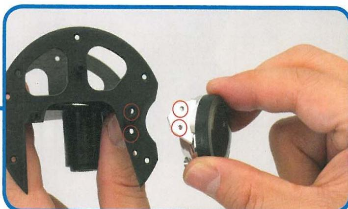
**15** Reggere come in foto l'ossatura della testa assemblata in precedenza. Il lato dell'occhio con i due fori va rivolto all'esterno. Allineare i fori per le viti con il terzo e quarto foro della tempia partendo dal basso.
