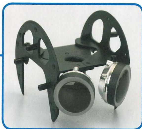
**19** Ecco il risultato dopo aver fissato correttamente gli occhi all'ossatura della testa. Gli occhi montati risultano rivolti verso l'esterno.
