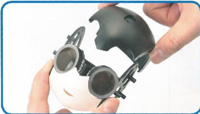
**1** Procedere a inserire la copertura della fronte come mostrato nella foto, incastrando la parte più stretta della copertura della fronte nell'incavo tra gli occhi nella parte anteriore della testa di Robi.
