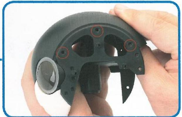
**2** Inserire la copertura della fronte tra le due tempie della testa in modo da allineare i tre fori delle viti evidenziati nella foto, che offre una chiara vista laterale (sinistra) di come posizionare la copertura.
