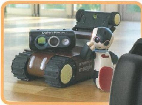
Il robot Moogle capace di ispezionare sotto il pavimento
