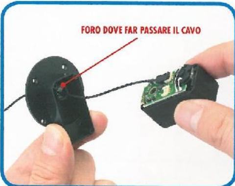
**19** Preparare la base del collo (2) come da foto facendo passare il servo cavo attraverso il foro della base.
