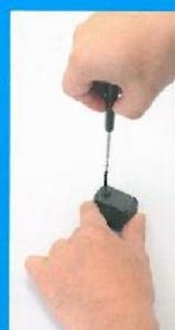
Se risulta difficile stringere la vite tenendo i pezzi in una mano, appoggiare il servomotore sopra un piano e stringere la vite come in foto. Attenzione a non ferirsi la mano con il cacciavite.
