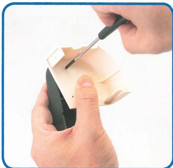
**4** Preparare una vite M2 x 6 mm **(5)**, inserirla nel foro in alto e avvitare bene con il cacciavite. Fare attenzione a non usare troppa forza.
