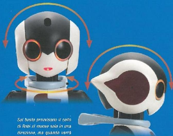
Sul busto provvisorio il collo di Robi si muove solo in una direzione, ma quando verrà completato si potrà muovere in tre direzioni. Potrà chinare la testa, con un movimento molto naturale.
