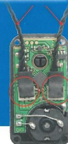
Il servomotore di Robi ha due connettori che servono a collegare un servomotore all'altro. In serie, trasportando il segnale da un servomotore all'altro.
