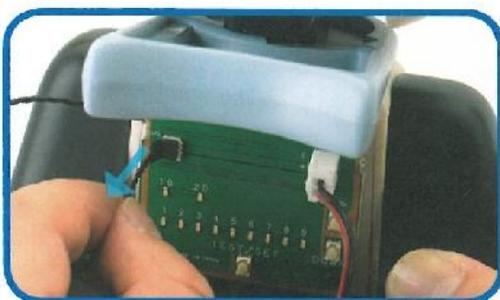
**21** Collegare di nuovo il cavo del servomotore del collo al connettore del Servo Tester V2. Posizionare l'interruttore su [OFF] e staccare il cavo del servomotore del gomito destro tirandolo verticalmente.
