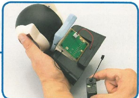
**12** Preparare il servomotore del gomito destro completo del cavo collegato precedentemente.
