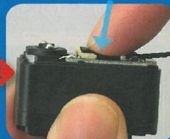
*Premere su tutta la superficie del connettore del servo cavo con un dito, in modo da inserirlo con precisione nel connettore bianco del servomotore.*
