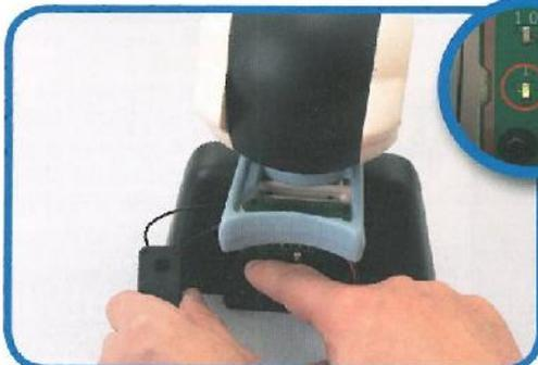
**13** Con il servo collegato mettiamo l'interruzione su [OFF] e poi mettiamo di nuovo su [ON]. Tutti i LED lampeggiano 2 volte e dopo rimane acceso solo il LED [1].
