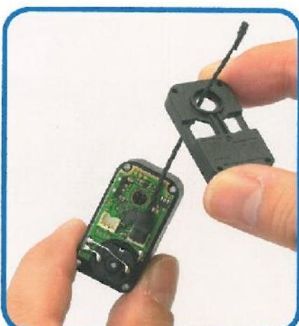
**4** Far passare il servo cavo nel foro circolare del coperchio posteriore che è stato rimosso al punto 2.
