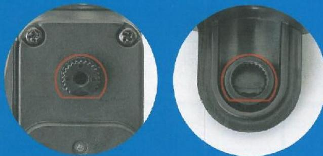
Il D-cut del servomotore e quello della squadretta della spalla che vengono uniti al punto 6.
