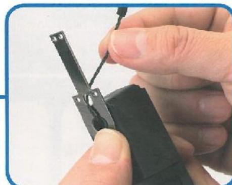
**4** Portare in tensione il cavo verticalmente in modo che aderisca al giunto facendo bene attenzione a non staccarlo dal servomotore.
