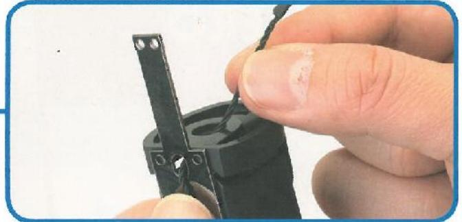
**8** Tirare verticalmente il cavo tenendolo premuto sul giunto per evitare che si stacchi dal connettore del servomotore.
