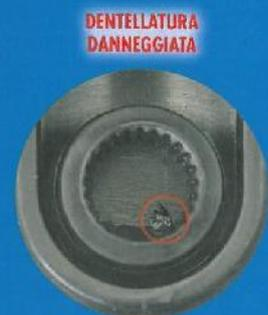
Quando si usa la forza senza unire correttamente i D-cut si rischia di rovinare la dentellatura che circonda il foro: state attenti.
