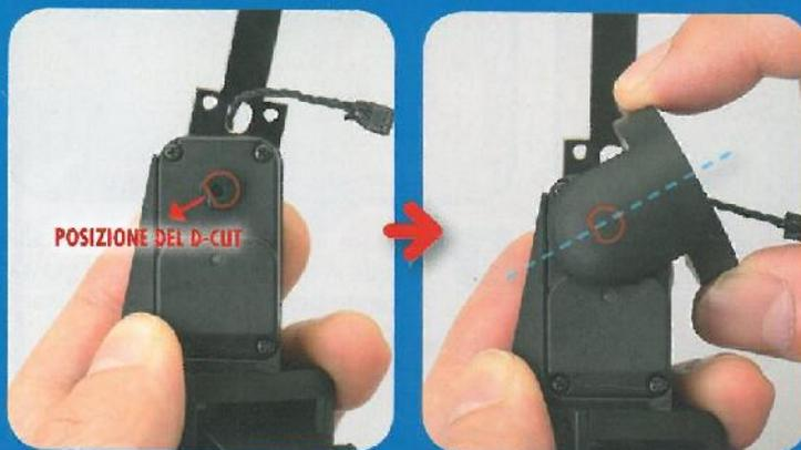
Esempio di servo con D-cut ruotato di 45°.
