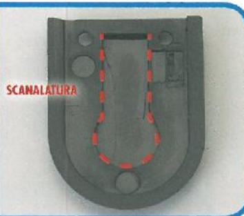
**9** Preparare la placca della spalla (1) e sovrapporla al giunto. Nella foto a destra è mostrato l'interno della placca dove è presente una scanalatura (area tratteggiata) in cui deve alloggiare il servo cavo quando la placca verrà sovrapposta al giunto.
