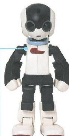
ID 16 SPALLA DESTRA Rotazione verticale
