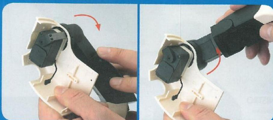
Come ulteriore verifica: muovere il braccio delicatamente verso il basso e verso l'alto e verificare che le teste delle due viti non ostacolino la rotazione della corona del servomotore. Se così fosse, stringere ancora meglio le viti.
