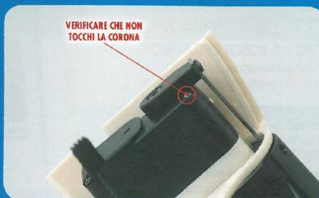
Guardando di lato controllare che la testa delle viti non sporga, altrimenti c'è il rischio che possa frenare il movimento della corona.
