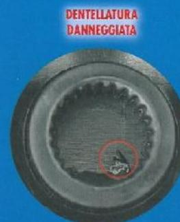
Quando si usa la forza per unire il D-cut si rischia di rovinare la dentellatura che circonda il foro: state attenti.
