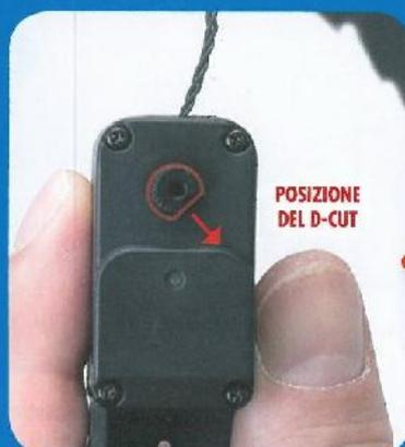
Esempio di servo con D-cut ruotato di 45°.
