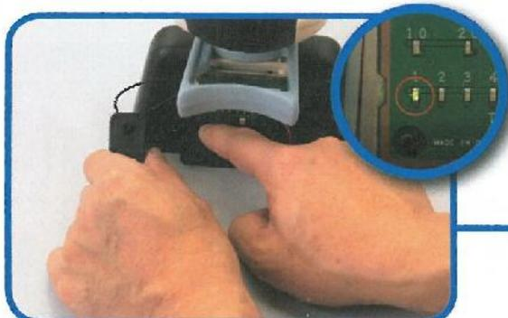
**13** Con il servo collegato mettiamo l'interruttore su [OFF] e poi mettiamo di nuovo su [ON]. Tutti i LED lampeggiano 2 volte e dopo rimane acceso solo il LED [1].
