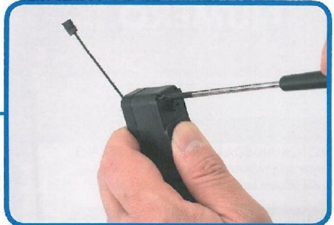
**19** Fissare il servomotore al braccio sinistro utilizzando le 4 viti rimosse in precedenza.
