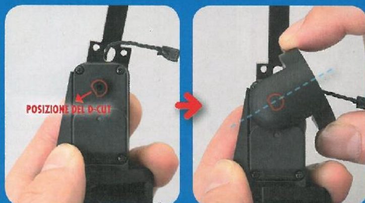
Esempio di servo con D-cut ruotato di 45°.
