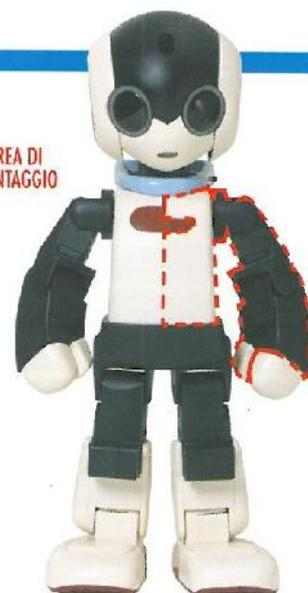
po e inizieremo le operazioni per il montaggio della gamba destra. Il servo cavo fornito in questa uscita è lungo ben 20 cm e verrà collegato al servomotore del piede destro.
