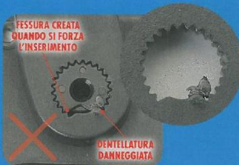
*Se forzate l'inserimento dell'albero del servo senza far combaciare i D-cut si rovina la dentellatura.*
