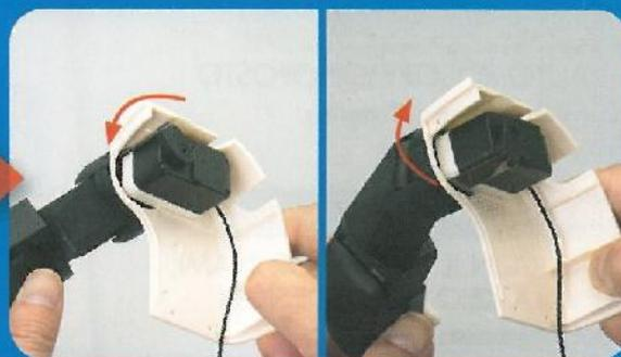
Verificare che le teste delle 2 viti del servomotore, vicine alla corona, siano state bene avvitate. Guardando ogni vite lateralmente controllare che la testa non vada a toccare la corona del servomotore. Se la vite sporge, è necessario stringere ancora.
