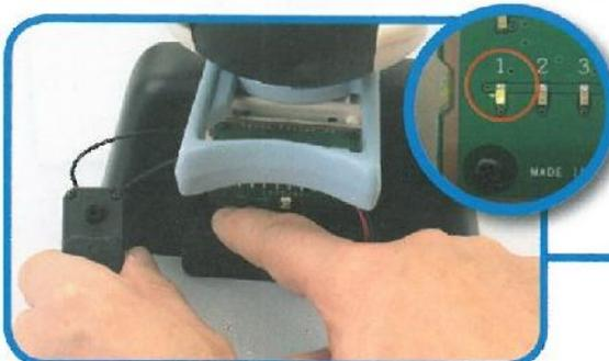
**13** Con il servo collegato posizioniamo l'interruttore su [OFF] e poi mettiamo di nuovo su [ON]. Tutti i LED lampeggiano 2 volte e dopo rimane acceso solo il LED [1].
