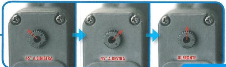
**10** L'albero del servomotore girerà di 45° sia a sinistra sia a destra e poi si fermerà nella posizione iniziale. Non spegnere la scheda perché ora imposteremo l'ID del servomotore.
