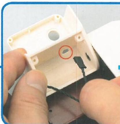
**12** Far poi passare il cavo nel foro rettangolare del telaio della caviglia destra.
