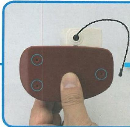
**25** Capovolgere il piede facendo attenzione a non far staccare i due componenti. Avvitare le viti M2 x 8 mm **(3)** nei tre fori sulla base del piede.
