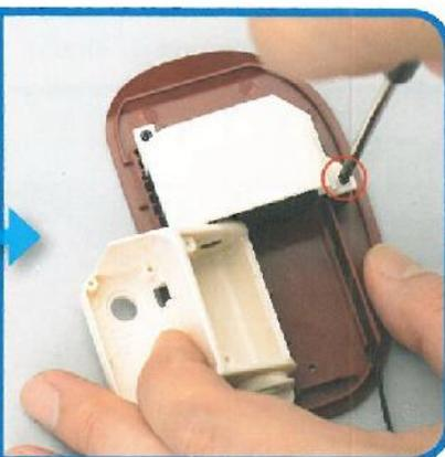
**9** Avvitare le viti M2 x 6 mm **(4)** nei due fori in alto e a destra del piede interno destro.
