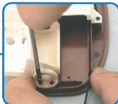
**10** Avvitare le viti M2 x 6 mm anche nei due fori della caviglia destra. Notiamo che il servo cavo deve rimanere ben steso nell'incavo.
