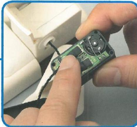
**8** Collegare il servo cavo della caviglia al connettore libero del servo. Sovrapporre perfettamente il connettore maschio del cavo al connettore femmina della scheda, premere con un dito sul connettore del cavo per fissarli tra loro.
