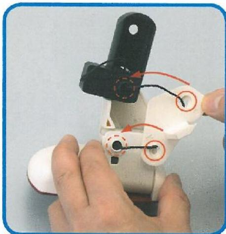
**15** Osservare il retro del polpaccio interno e identificare le concavità intorno ai due fori cerchiati in rosso. Faremo poi combaciare le concavità con i fori in rilievo del femore e del telaio della caviglia (tratteggiati in rosso) come indicato dalle frecce.
