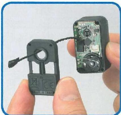
**4** Far passare il servo cavo dalla parte interna nel foro circolare del coperchio rimosso nel punto 2.
