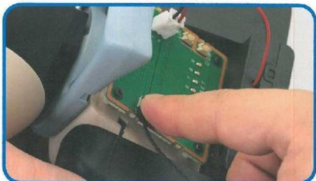
**7** Preparare il busto provvisorio. Se il servo cavo del servo del collo è ancora collegato, staccarlo tirando verticalmente. Collegare il connettore del cavo, che abbiamo collegato al servo in questa uscita, al connettore del ServoTester V2.
