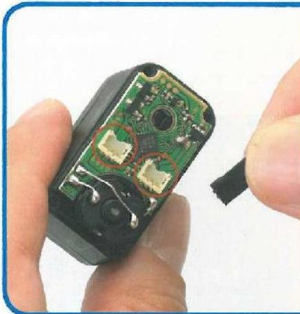
**3** Preparare il servo cavo, fornito nell'uscita precedente, al quale abbiamo applicato l'adesivo di protezione e collegarlo a uno dei connettori della scheda (uno o l'altro è indifferente) premendo dall'alto con un dito.
