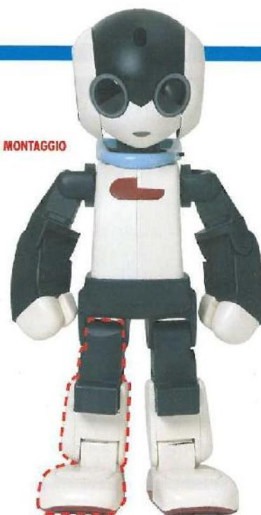
servo del ginocchio e inserito nel femore destro utilizzando le viti del servomotore.
