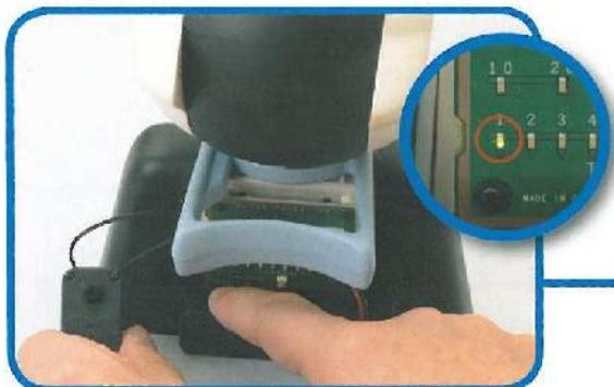
**13** Con il servo collegato posizioniamo l'interruttore su [OFF] e poi mettiamo di nuovo su [ON]. Tutti i LED lampeggiano 2 volte e dopo rimane acceso solo il LED [1].
