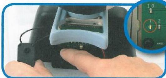
**13** Con il servo collegato posizioniamo l'interruttore su [OFF] e poi mettiamo di nuovo su [ON]. Tutti i LED lampeggiano 2 volte e dopo rimane acceso solo il LED [1].
