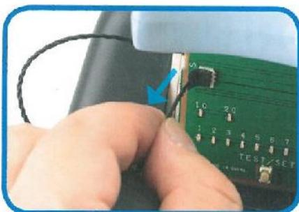
**15** Posizionare l'interruttore su [OFF] e staccare il servo cavo del servomotore di questa uscita dal busto provvisorio tirando verticalmente come indicato dalla freccia azzurra. Possiamo non collegare di nuovo il servo cavo del collo al Servo Tester V2, per evitare di usurare i connettori.
