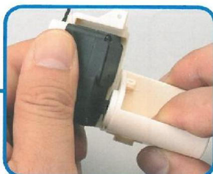
**2** Inserire l'albero del servo nel foro corrispondente del telaio della caviglia (senza forzare per non rovinare la dentellatura dell'albero), facendo in modo di inserire l'albero fino in fondo.
