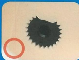
Quando il D-cut è posizionato correttamente, l'albero si inserisce facilmente nel foro.
