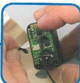
**6** Se i collegamenti erano corretti, procedete a staccare il cavo dal connettore indicato e rimuovete il servo della spalla.
