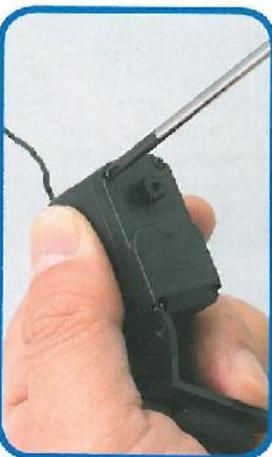
**20** Staccare le 4 viti del servomotore.
