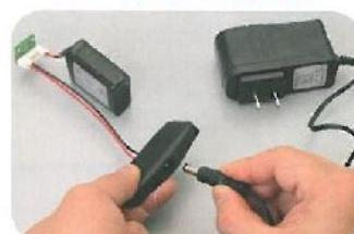
Controllare lo stato di carica della batteria. Nel caso, caricare la batteria finché il LED del caricatore diventa verde (vedi fasi 7-17 dell'uscita 41).
