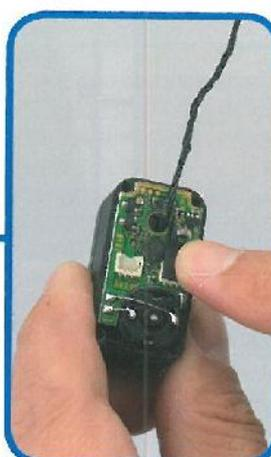
**22** Controllare che il servo cavo sia stato collegato perfettamente al connettore della scheda.
