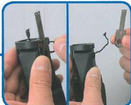
**9** Estrarre il servo cavo dal foro del giunto metallico e dal foro della squadretta della spalla, poi staccare il giunto.
