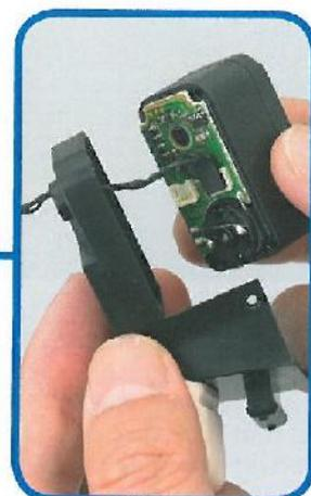
**21** Inserire l'accessorio rimuovi servo nel foro del telaio dell'avambraccio e staccare il servo facendo attenzione a non far sollevare la scheda.
