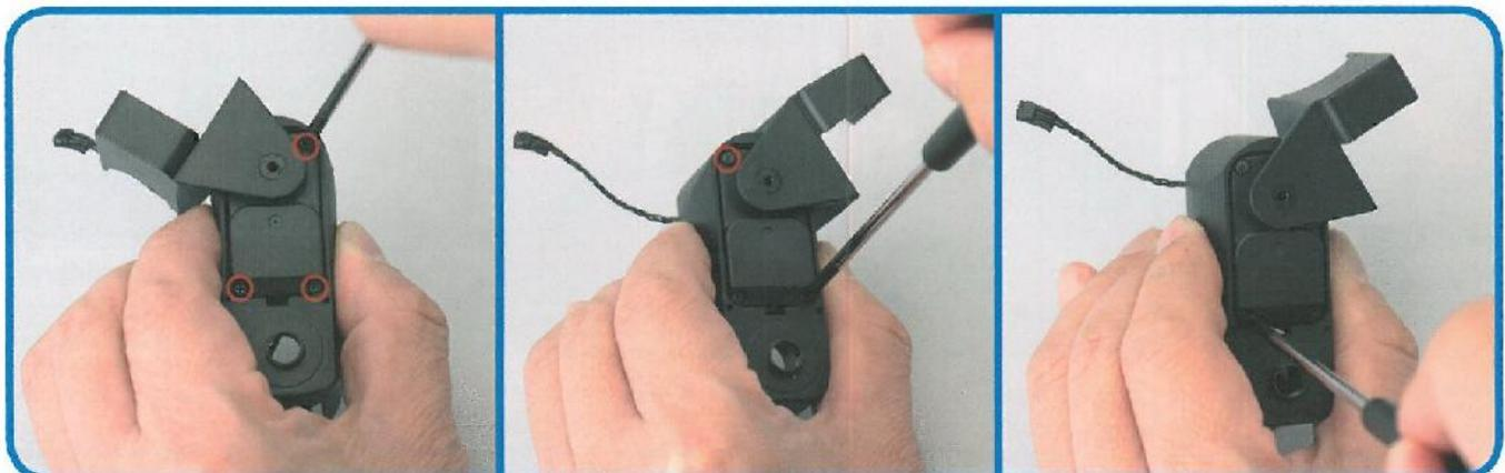
**20** Staccare le 4 viti del servo dell'articolazione dell'anca (rotazione verticale) spostando l'anca interna verso destra e sinistra.
