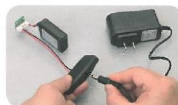
Controllare lo stato di carica della batteria. Nel caso, caricare la batteria finché il LED del caricatore diventa verde (vedi fasi 7-17 dell'uscita 41).
