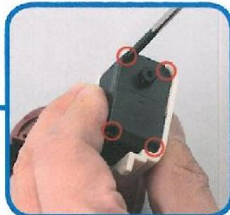
**4** Staccare le 4 viti del servo della caviglia (oscillazione laterale).
