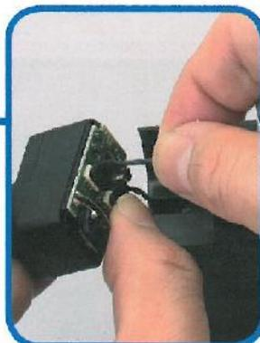
**14** Staccare dal connettore il cavo collegato al secondo servo della caviglia (rotazione verticale).
