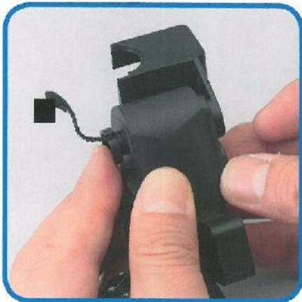
**21** Staccare il servo dell'articolazione dell'anca (rotazione verticale) inserendo l'accessorio rimuovi servomotore.
