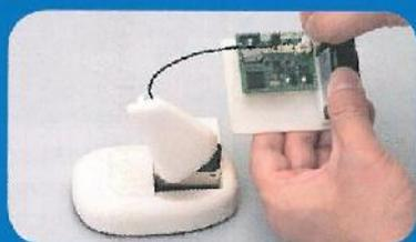
Collegare il servo cavo al secondo connettore, contando dallo slot della SD Card, e collegare la batteria.
