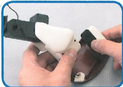
**3** Estrarre il servo della caviglia all'estremità (oscillazione laterale) dal telaio della caviglia destra.
