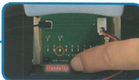
**27** Collegare il servo dell'articolazione dell'anca (rotazione verticale) al Servo Tester V2 e premere il tasto [TEST/SET] e verificare se è impostato il numero [3]. Se così non fosse impostare l'ID [3] seguendo le istruzioni dell'uscita 31.
