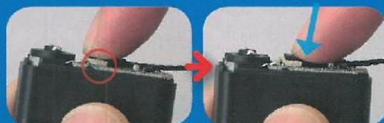
Premere su tutta la superficie del connettore del servo cavo con un dito, in modo da inserirlo con precisione nel connettore bianco del servomotore.
