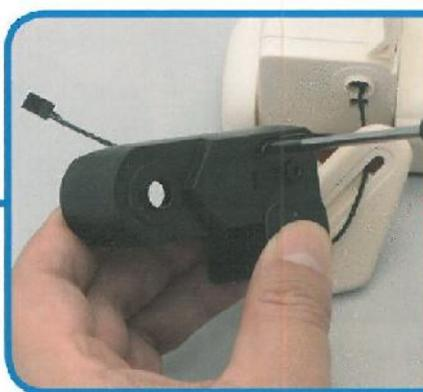
**12** Fissare il servo al femore servendosi delle 4 viti staccate al punto 6.
