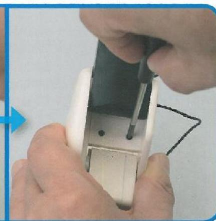
**20** Inclinando leggermente la parte superiore della caviglia verso la punta del piede si può controllare con più facilità. Fissare il polpaccio interno sinistro usando le 2 viti M2 x 7 mm **(3)**.
