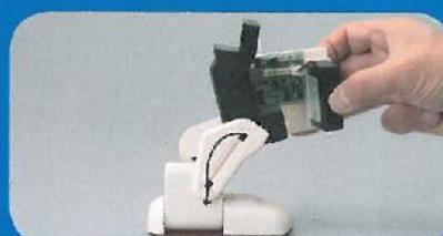
Poi i tre servo con rotazione verticale girano e portano la gamba nella posizione in foto per poi tornare nella posizione di partenza.
