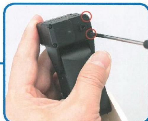
**14** Fissare il servo all'anca esterna destra utilizzando le 2 rimanenti viti.
