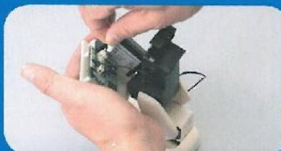
Collegare il cavo al secondo connettore contando dallo slot della SD Card e collegare la batteria.
