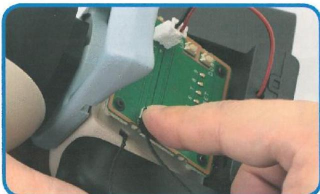
**7** Preparare il busto provvisorio. Se il servo cavo del servo del collo è ancora collegato, staccarlo tirando verticalmente. Collegare il connettore del cavo, che abbiamo collegato al servo in questa uscita, al connettore del Servo Tester V2.
