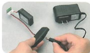
Controllare lo stato di carica della batteria. Nel caso, caricare la batteria finché il LED del caricatore diventa verde (vedi fasi 7-17 dell'uscita 41).
