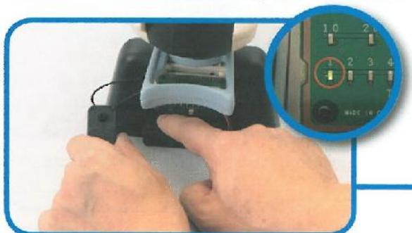
**13** Con il servo collegato posizioniamo l'interruttore su [OFF] e poi mettiamo di nuovo su [ON]. Tutti i LED lampeggiano 2 volte e dopo rimane acceso solo il LED [1].
