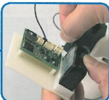
**28** Posizionare la batteria sul supporto e collegare il cavo al connettore della batteria. **Appena collegata la batteria la gamba si muove subito, quindi state attenti.**
