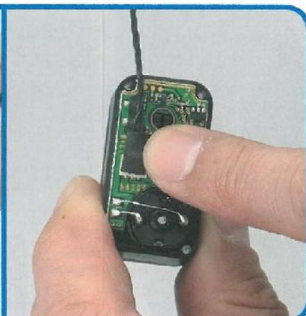
**3** Preparare il servo cavo, fornito nell'uscita precedente, al quale abbiamo applicato l'adesivo di protezione e collegarlo a uno dei connettori della scheda (uno o l'altro è indifferente) premendo verticalmente con un dito.
