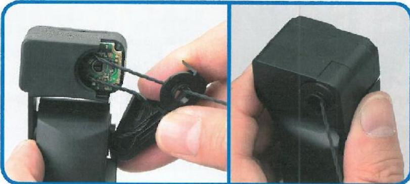
**23** Mettere il cavo nell'incavo rettangolare verificato al punto 22 facendo attenzione a non far incastrare il cavo nel telaio, inserire il foro in rilievo del femore nella parte circolare e unire i due componenti. Se il cavo è stato posizionato bene i due componenti si uniscono perfettamente come si vede nella foto.
