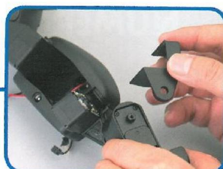
**12** Ora rimuovere l'anca interna dall'albero del servo dell'anca con rotazione verticale e reinserite il pezzo facendo attenzione a far combaciare correttamente i D-cut.
