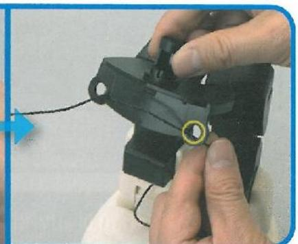
**5** Far passare dall'interno il servo cavo della gamba destra nel foro cerchiato in rosso nella foto a sinistra. Far passare allo stesso modo il servo cavo della gamba sinistra nel foro cerchiato in giallo nella foto a destra.
