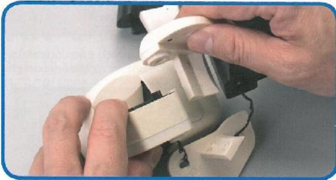
**7** Staccare il D-cut della parte inferiore della tibia tirandolo verso l'esterno.
