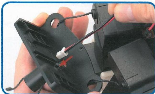
**12** Sollevare il bacino portandolo nella posizione mostrata in foto, in modo da vederne la parte inferiore. Inserire il cavo di alimentazione che fuoriesce dalla copertura posteriore nel foro alla base del cilindro del bacino.
