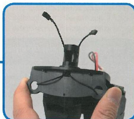
**11** Nella foto si vedono i due servo cavi delle gambe correttamente inseriti nel bacino.
