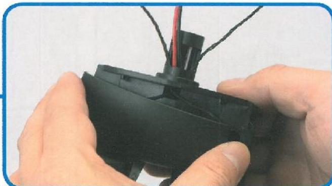
**20** Unire la copertura anteriore al bacino, inserendola dal basso in modo che i perni del bacino si inseriscano nei fori della copertura anteriore. Prestiamo attenzione a non schiacciare i servo cavi.
