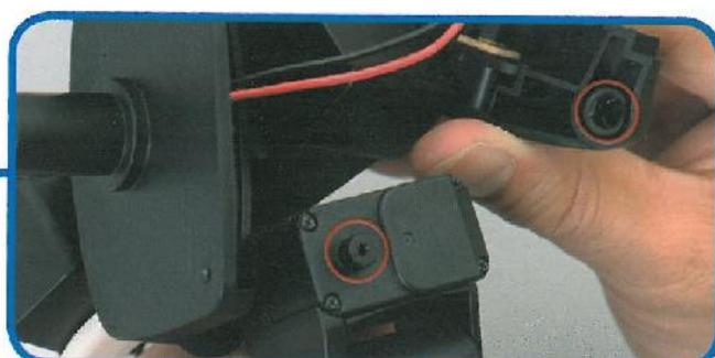
**15** Controllare il D-cut del servo dell'anca con oscillazione laterale e quello della copertura posteriore, riassembleare inserendo i D-cut correttamente.
