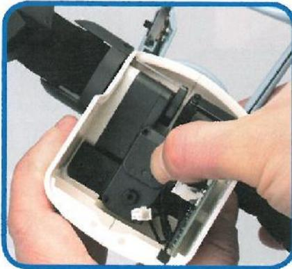
**16** Ora posizionare il servo del busto come in foto, con l'albero verso il basso (verso la parte anteriore del busto) e inserire il servo nella sua sede sul supporto dell'altoparlante facendo attenzione a non schiacciare i cavi.
