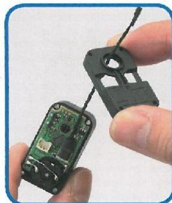
**3** Preparare il servo cavo, fornito nell'uscita precedente, e collegarlo al connettore destro (cerchiato in rosso nella foto sopra a sinistra) premendo verticalmente con un dito.
