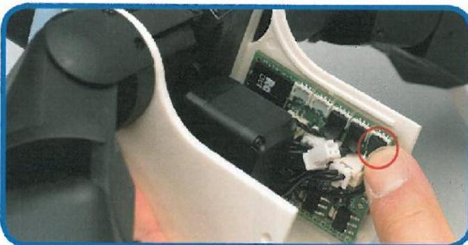
**19** Collegare il cavo del servo del busto al primo connettore della scheda CPU (cerchiato in rosso nella foto), ovvero il più lontano dallo slot della SD Card. Inserire il connettore premendo con un dito.
