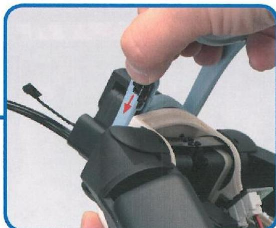
**7** Posizionare l'interruttore sul lato della sciarpa su ON (in direzione della freccia). **Attenzione, le braccia di Robi inizieranno a muoversi subito.**
