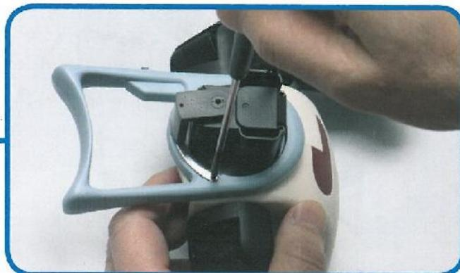
**2** Avvitare la placca utilizzando la vite M2 x 6,2 mm a gradini **(8)**. Non stringere troppo perché la placca non deve essere fissata completamente per far in modo che il collo possa girare.
