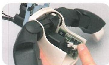
Controllate di aver inserito bene il servo cavo del busto, non solo l'estremità del connettore, ma tutto il connettore del cavo, premendo con un dito.
