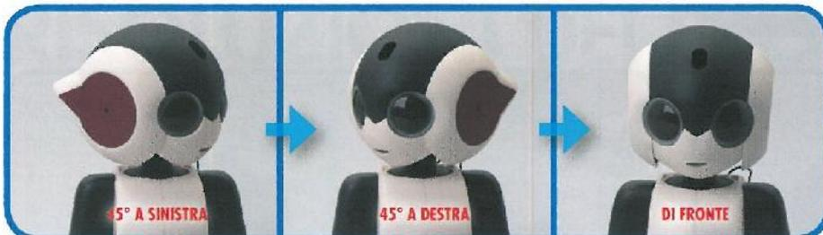
**22** Premere l'interruttore [TEST/SET]. L'albero del servomotore girerà di 45° sia a sinistra sia a destra e poi si fermerà nella posizione iniziale. Non spegnere la scheda perché ora imposteremo l'ID del servomotore.
