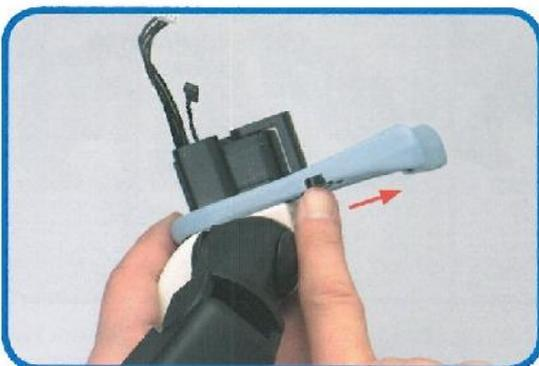
**3** Tenere il busto anteriore come mostrato in foto e posizionare l'interruttore sul lato della sciarpa su OFF (in direzione della freccia).
