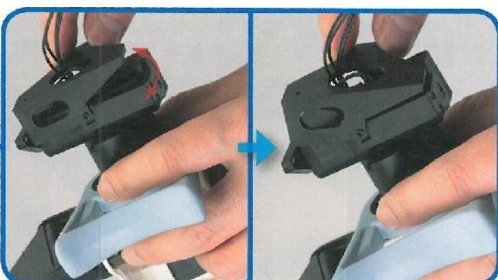
**12** Inclinare la base della testa a destra e a sinistra in direzione delle frecce rosse. Se non si riesce a inclinare oppure il movimento non risulta fluido, significa che una o entrambe le viti fissate ai punti 9 e 11 sono state strette troppo. Svitare leggermente le viti e verificare nuovamente.
