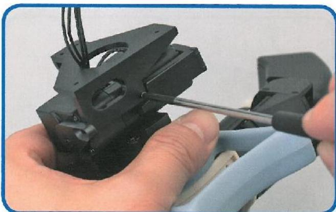
**9** Fissare la base della testa alla leva utilizzando la vite M2 x 6,2 mm a gradini (5). Non serrare completamente la vite lasciandola leggermente allentata.
