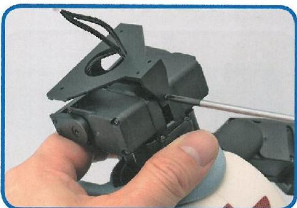
**11** Fissare la base della testa utilizzando la vite M2 x 6,7 mm (6). Non serrare completamente la vite lasciandola leggermente allentata.
