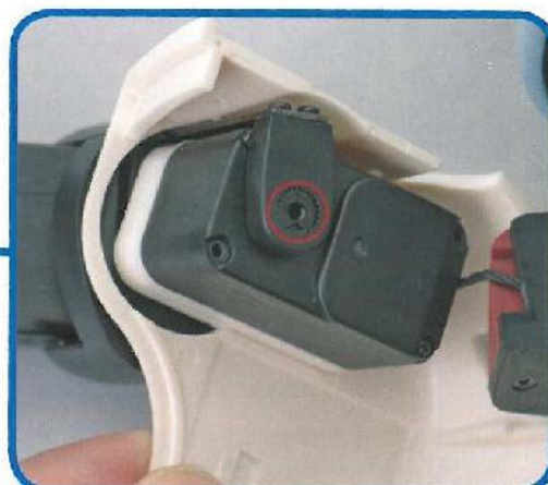
21 Controllare il D-cut della corona del servo della spalla (oscillazione laterale). Prestare attenzione a non far scollegare i vari cavi collegati al busto di Robi.
