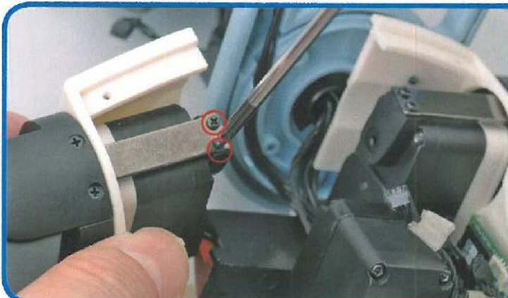
22 Svitare le 2 viti del giunto della spalla e rimuovere la corona del servo della spalla (rotazione verticale).
