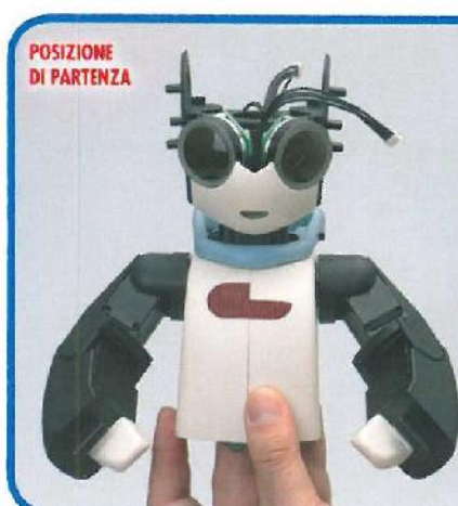
22 Svitare le 2 viti del giunto della spalla e rimuovere la corona del servo della spalla (rotazione verticale).
