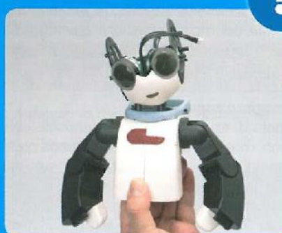
MONTAGGIO ERRATO DEL COLLO
