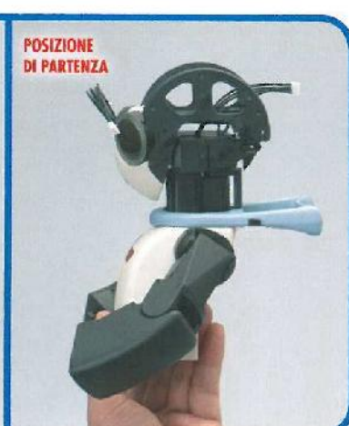
22 Svitare le 2 viti del giunto della spalla e rimuovere la corona del servo della spalla (rotazione verticale).
