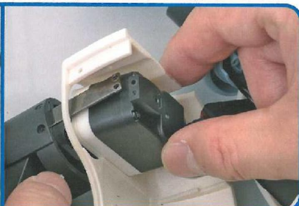
22 Svitare le 2 viti del giunto della spalla e rimuovere la corona del servo della spalla (rotazione verticale).
