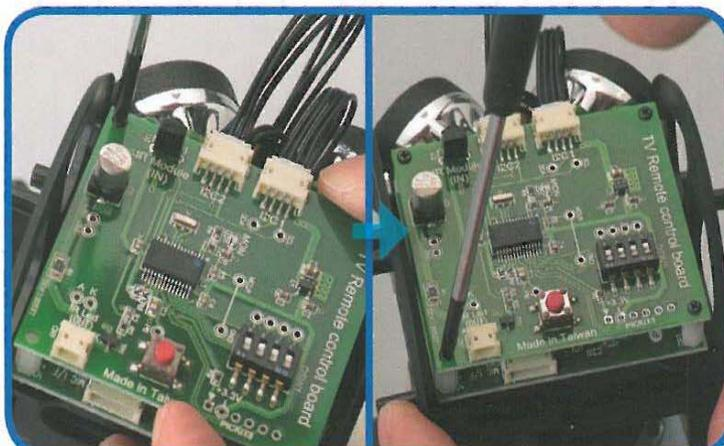
**10** Fissare la scheda con le 4 viti M2 x 5 mm a testa cilindrica fornite nell'uscita 64. Avvitare lentamente, evitando di stringere eccessivamente per non deformare la testa esagonale delle viti di plastica.
