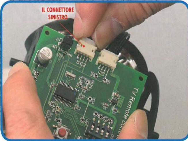
**7** Inserire il connettore maschio del cavo nel connettore femmina sinistro della scheda telecomando.
