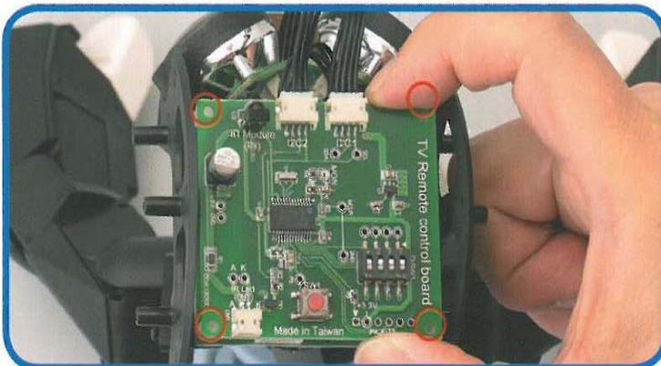
**9** Sovrapporre la scheda telecomando alla scheda per il riconoscimento vocale e far combaciare i fori dei quattro angoli con i fori presenti sulle viti di plastica a testa esagonale presenti ai quattro angoli della scheda per il riconoscimento vocale.
