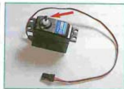
Sopra. Il primo servomotore Parallax. Per il montaggio della ruota, va rimossa la vite nera del perno (indicata dalla freccia).
