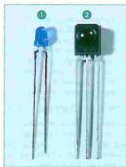
● Sopra. I due componenti (il LED emettitore ① e il ricevitore ②) del primo sensore IR, che alloggeremo in seguito sulla scheda DeA Back Sensors.
